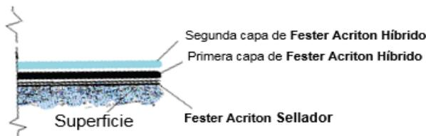
1.1 En techos de láminas, deberá hacerse la limpieza correspondiente mediante chorro de agua presurizada, detergente y restregado con cepillos hasta lograr la limpieza, esto independientemente de que sea un techo con lámina nueva (estas traen grasas), lámina intemperada o con sistema existente.
